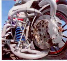
Mächtige Achsschenkellenkung und innen belüftete Bremscheibe mit gleich zwei Bremsätteln (oben). Länge läuft: Die Schwinge wurde verlängert und mittels doppelter Querlenker am Bootsrahmen abgestützt (links).
