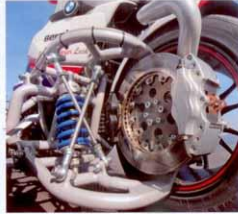
Mächtige Achsschenkellenkung und innen belüftete Brems Scheibe mit gleich zwei Bremsätteln (oben). Länge läuft: Die Schwinge wurde verlängert und mittels doppelter Querlenker am Bootsrahmen abgestützt (links).
